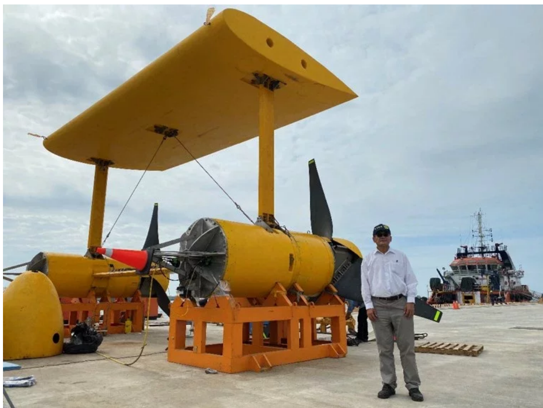
此為黑潮發電實海試驗20 kW機組，預計一至兩年內將100 kW渦輪發電機下水測試。吳朝榮提供
